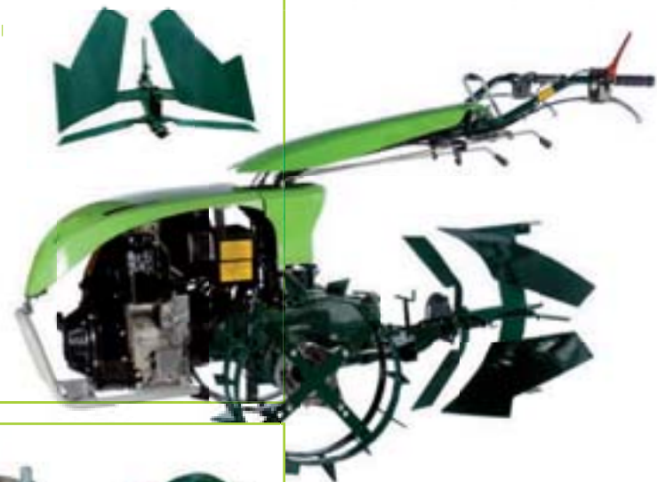
JEDNOBRAZDNI OKRETNI PLUG PJO 180° Dubina oranja: 20 cm
